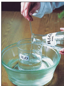
Рис. 14. Правильное приготовление разбавленного раствора сульфатной кислоты
