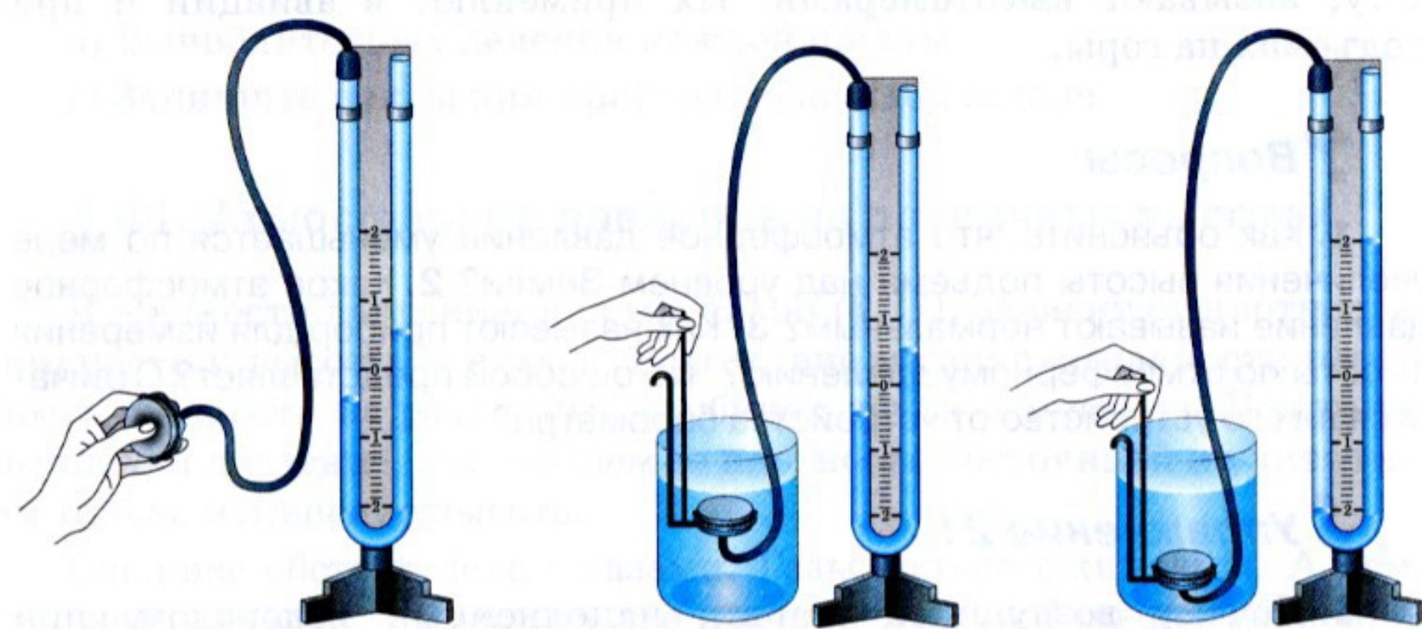
Чтобы понять, как работает такой манометр, его можно соединить резиновой трубкой с круглой плоской коробкой, одна сторона которой затянута резиновой пленкой (рис. 126). Если слегка надавить пальцем на пленку, то уровень жидкости в колене манометра, соединенном с коробкой, понизится, в другом колене повысится. Чем это объясняется?
