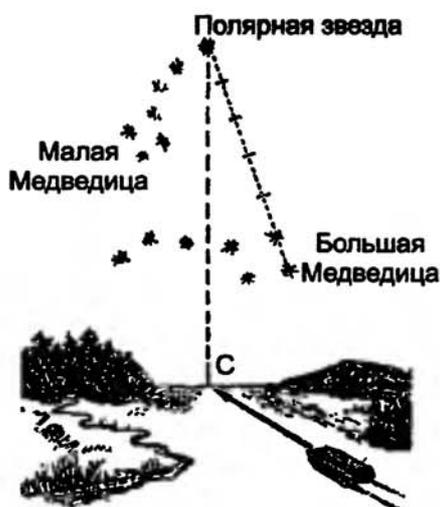
Ил. 29.11. Определение сторон горизонта по Полярной звезде
