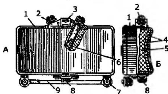
Ил. 10.6. Строение противопехотной мины МОН-50: А — вид спереди с разрезом по гнезду запала, в сложенном положении; Б — вид сбоку с разрезом передней части мины: 1 — корпус мины; 2 — пробка; 3 — прицельная щель; 4 — убойные элементы; 5 — заряд взрывчатого вещества; 6 — одно из двух гнезд для запала; 7 — шарнир; 8 — втулка; 9 — ножки мины в сложенном положении
