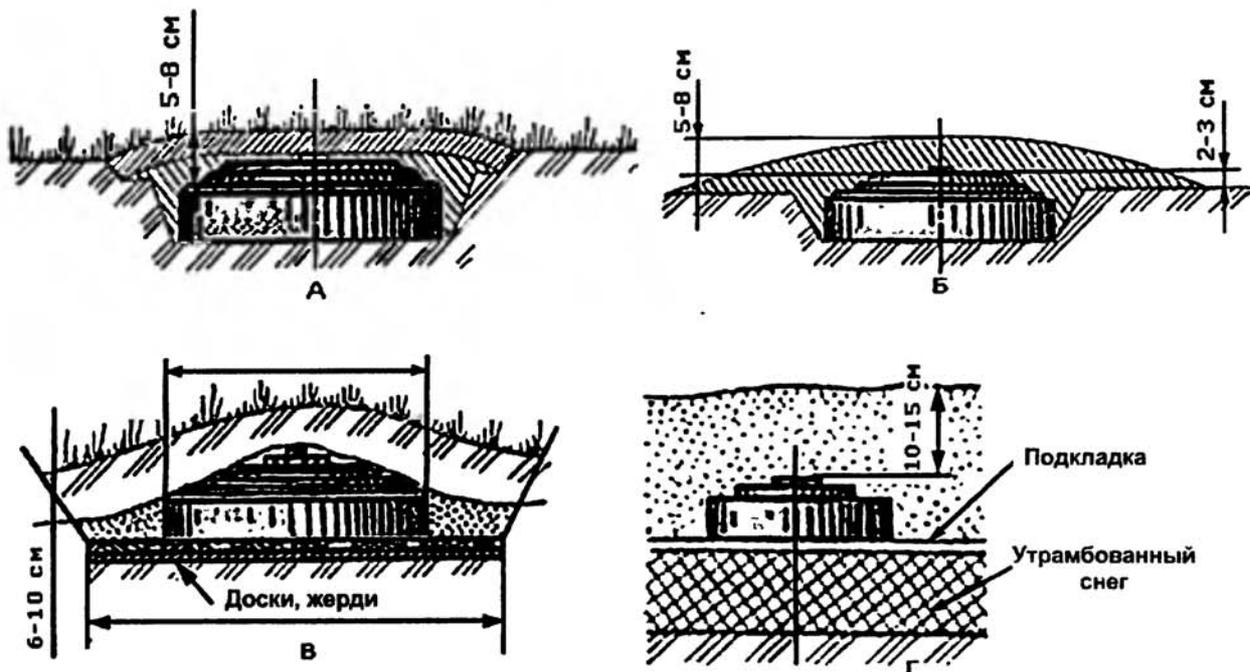
Ил. 10.2. Установка противотанковой противогусеничной мины ТМ-57:
